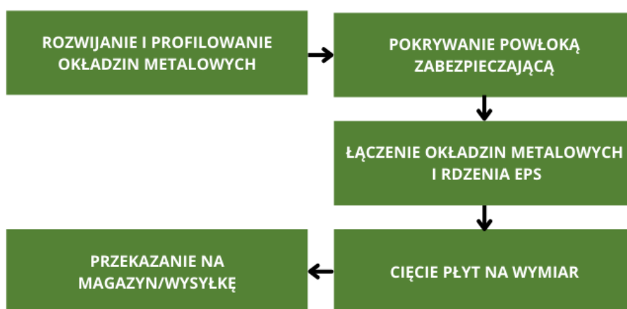
Rysunek 5.2: Schemat procesu produkcyjnego płyt warstwowych z rdzeniem EPS
